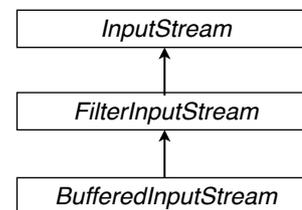
La classe `BufferedInputStream` legge una sequenza di byte che mette in un buffer interno (ottimizza la lettura).
