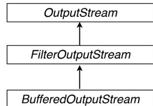
La classe **BufferedOutputStream** sfrutta un buffer interno per ottimizzare la scrittura (che avviene effettivamente solo nel momento in cui tale buffer risulta pieno (o viene eseguita una *flush*)).
